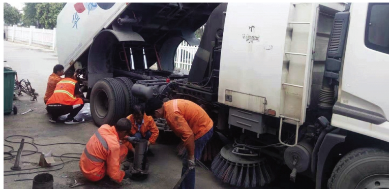
近年来,华茂瑞泰服务公司不断提升对大型清扫车、洒水车等机械设备自主维修能力,大幅降低维修成本,缩短修理时间,提高机械设备使用率。图为该公司机修人员对大型清扫车的扫盘、吸盘等机械故障进行维修,仅此项目就节约维修费用一万余元。(吴军兵)
